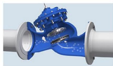
伯尔梅特 700SIGMA阀门的创新设计，可以从阀的中心引导其轴，因此不需要这样的支撑肋条，较大的杂物都可以自由通过阀门，从而不会对阀门造成任何损坏。
