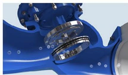
伯尔梅特 700SIGMA阀门具有标准的双腔结构，可保护膜片。在阀门关闭的起始过程中不需要弹簧，并且很容易在现场转换为不同的阀门应用和功能。这种标准配置允许更多的特殊应用，在低压条件下表现的尤为出色。
