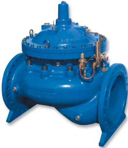
BERMAD-Regelventile der Reihe 700 in den Nennweiten DN 500 - DN 1200 sind hydraulisch betätigte Membranregelventile. Die Armatur besteht aus zwei Hauptteilen, dem Gehäuse und dem Ventilantrieb. Die Ventilantriebseinheit kann als eine Einheit aus dem Gehäuse ausgebaut werden.
