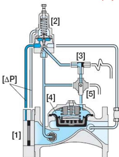
导流孔组件[1]前后的压差 $[\Delta P]$ 和流量成正比。流量导阀[2]持续感应压差 $[\Delta P]$ , 在流量超过导阀设置时使阀门缓闭。梭阀[3]将导阀压力引导进入主阀控制腔[4]。外接压力升高时, 梭阀自动切换, 将压力引导进入控制腔, 控制腔压力增大促使主阀关闭。利用手动选择装置[5]可实现本地手动关闭阀门。
