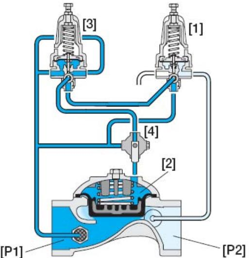
减压导阀[1]经持压导阀[3]连接到阀门控制腔[2]。持压导阀在阀前压力[P1]低于设置值时使阀门缓闭。阀前压力[P1]升高超过设置值时, 持压导阀进行切换, 使减压导阀控制阀门以降低阀后压力[P2]。利用手动选择装置[4]可实现本地手动关闭阀门。
