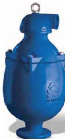
C60-SP 组合式空气阀 适用于污水和废水系统 球墨铸铁阀体 PN16, 2"-3", DN50-DN80 侧向出口, 具有防水锤功能
