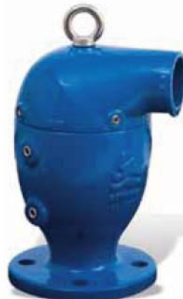
C70-SP 组合式空气阀 球墨铸铁阀体 PN16, 2"-8", DN50-200, 侧向出口, 具有防水锤功能
