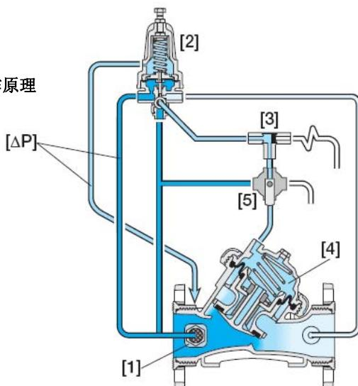
内部压差管[1]前后的压差 $[\Delta P]$ 和流量成正比。流量导阀[2]持续感应压差 $[\Delta P]$ , 在流量超过导阀设置时使阀门缓闭。梭阀[3]可将导阀压力引导进入主阀控制腔[4]。外接压力升高时, 梭阀自动切换, 将压力引导进入控制腔, 控制腔压力增大促使主阀关闭。利用手动选择装置[5]可实现本地手动关闭阀门。
