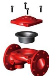
伯尔梅特 400 系列阀门内部仅有一个移动部件，维护时只需要旋下阀盖的四颗螺栓即可，维护过程极为快速方便。阀门的控制配件非常容易操作，无需经过专门培训，无需任何专业工具。
