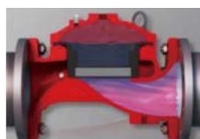
伯尔梅特 400 系列阀门的设计有效解决了传统隔膜阀出现漏失问题。阀门平衡式结构可确保多年不会出现漏失现象，也无需更换部件。阀门涂层均在伯尔梅特内部加工涂覆，配件采用不锈钢材料，确保阀门不受腐蚀从而延长使用寿命。
