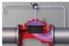
伯尔梅特 400 系列阀门采用“故障开启”设计理念，阀门内部没有机械式移动部件和可能造成卡堵现象的部件。阀门具有可靠性极高，出现火情时阀门总能正常开启。
