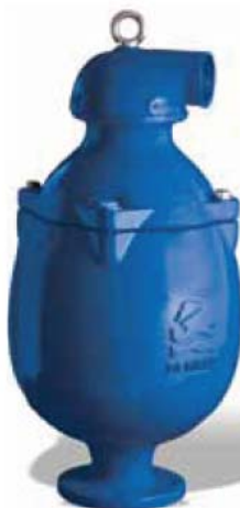
C60 组合式空气阀 适用于污水和废水系统 球墨铸铁阀体 PN16, 2"-3", DN50-DN80 侧向出口
